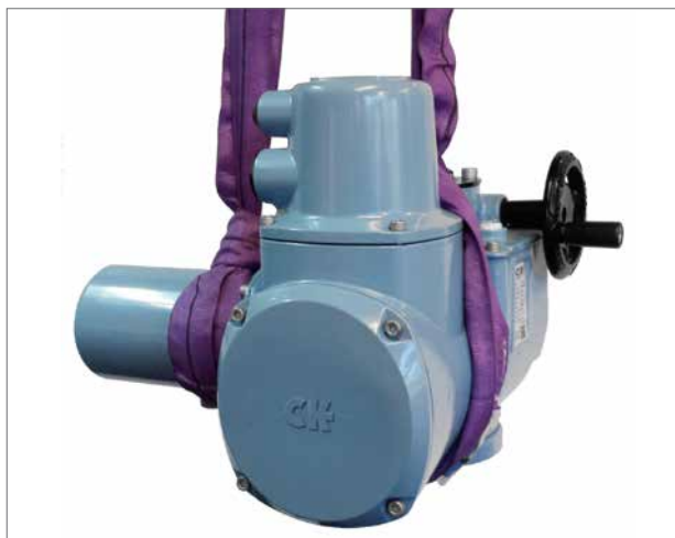
CK standardaktuator løftes i en strop.
